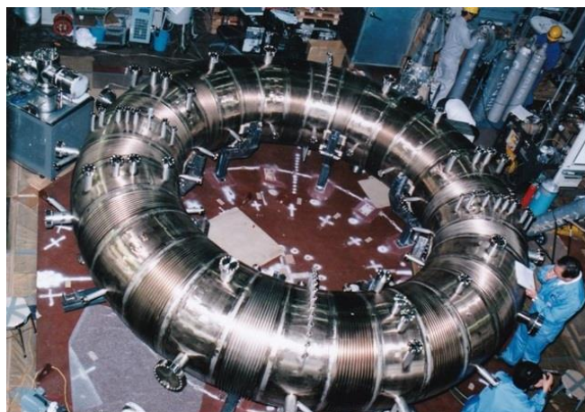
図 17 TPE-1RX装置の真空容器 ステンレス(SUS316L)製のベローズとストレートの一組を、 16個溶接で繋いでトーラスを作る。まだ絶縁シートを巻き つけない、本体に組み込む前の写真
