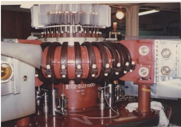
図 5 TPE-1R 装置 高速(10 \mu s)のRFP配位形成を行うトロイダルコイル(こげ茶色)、ポロイダルコイル兼二重構造の導電性シェル(赤茶色) 大きなコイル電流を高速で立ち上げるのに必要な高電圧(40kV)に耐えるため、エポキシ樹脂でコイルを覆う
