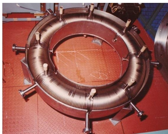
図 8 TPE-1RM 薄肉のステンレス製の容器。運搬時の固 定用治具に収めた状態の写真。 大円方向に8分割して、0.4 mm厚のペロー部を直管で 溶接。直管部に4本のポートを設けて、真空排気や各 種の計測に使用
