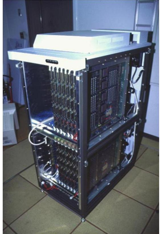
図3. 記号処理用データ駆動計算機 EM-4 と EM-X
