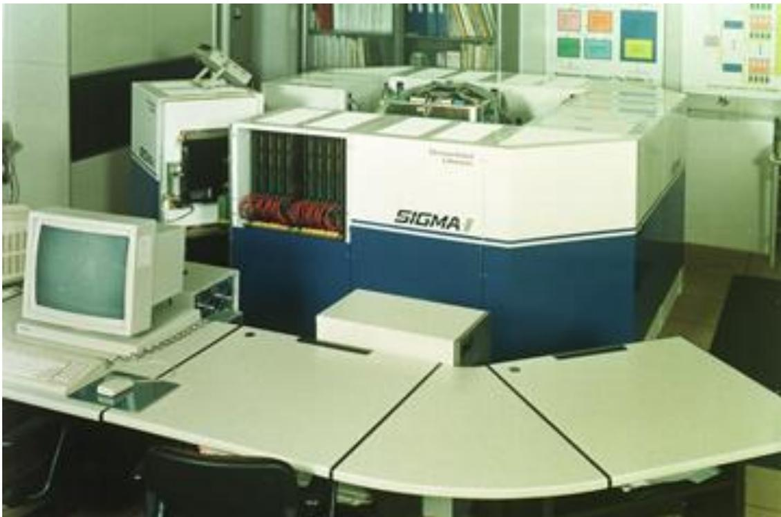
図1. 科学技術計算用データ駆動計算機 SIGMA-1
