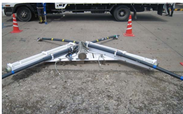
図 18 開発した海底 MT 法測定装置の外観。左右の白いケースにインダクション磁力計（長さ約 140cm）が、交差する 2 本のねずみ色のロッド（長さ 5m）の両端に電極（Ag-AgCl）が装着されている。台座中央の灰色円筒形の耐圧容器にデータ収録装置が収納されている。
