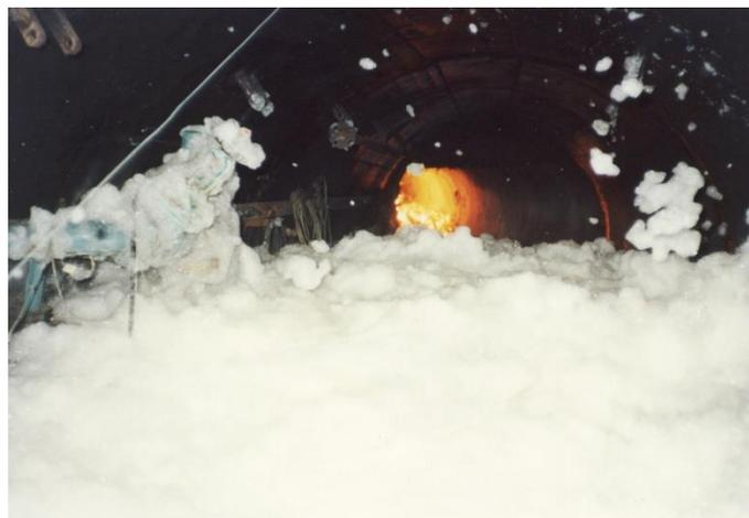
第 29 図 高膨張泡沫流送による坑内火災消火実験
