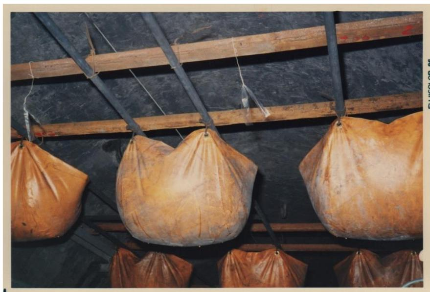
**第 10 図** 炭じん爆発伝ば防止用吊し水袋 (写真は容量 30 l の水袋)
