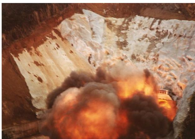
第7図 強制浮遊方式による 400m 試験坑道における炭じん爆発
