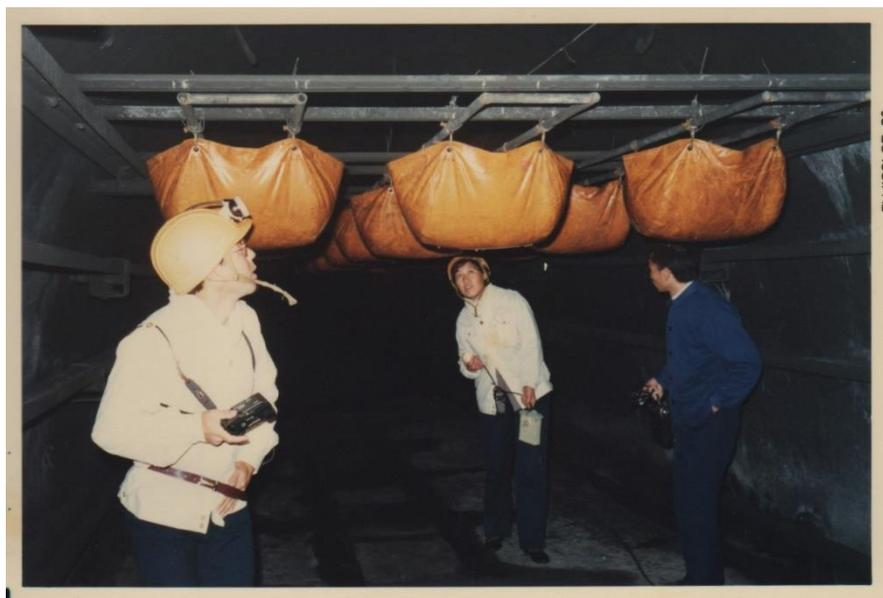
第 13 図 爆発試験坑道内に設置した吊し水袋<sup>4)</sup>
