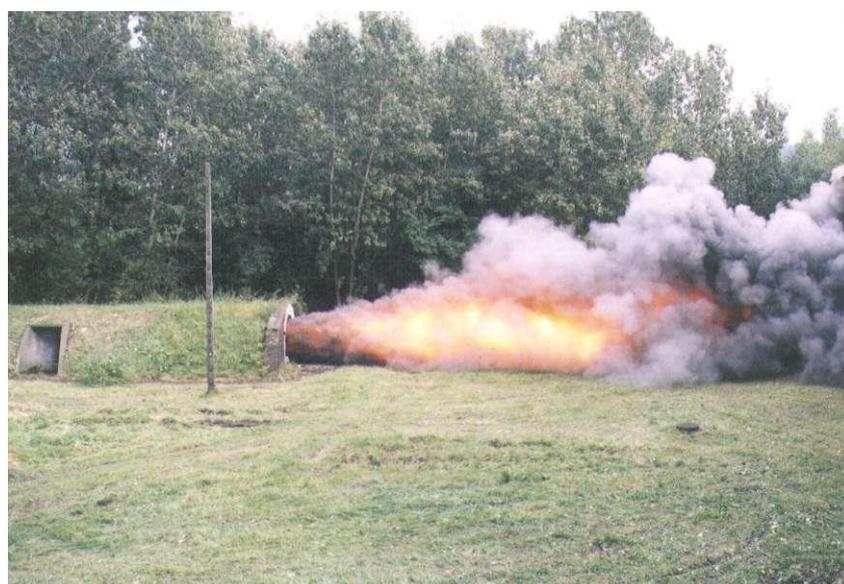
第 9 図 ポーランド・バーバラ試験炭鉱の爆発試験坑道
