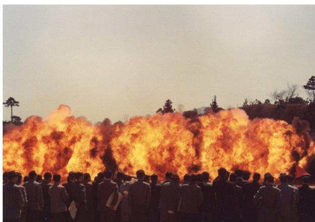
第6図 強制浮遊方式による空中炭じん爆発
