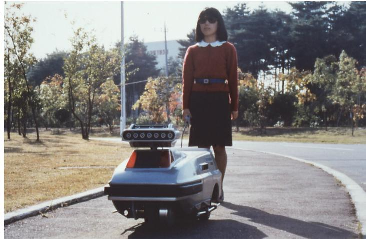
図6 盲導犬ロボット実験機 MELDOG MARK IV (1983年夏完成)
