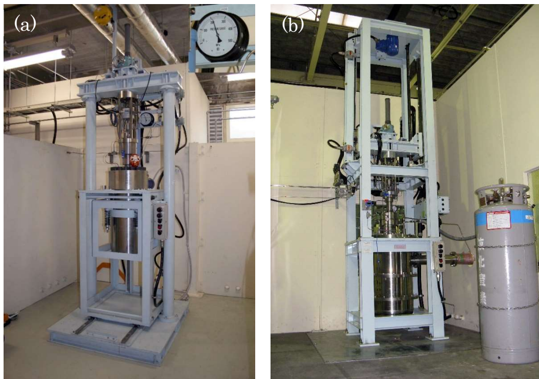
図 3. 高圧水素雰囲気材料試験機 ((a):室温 230MPa 試験機[9]、(b):低温 70MPa 試験機[1])
