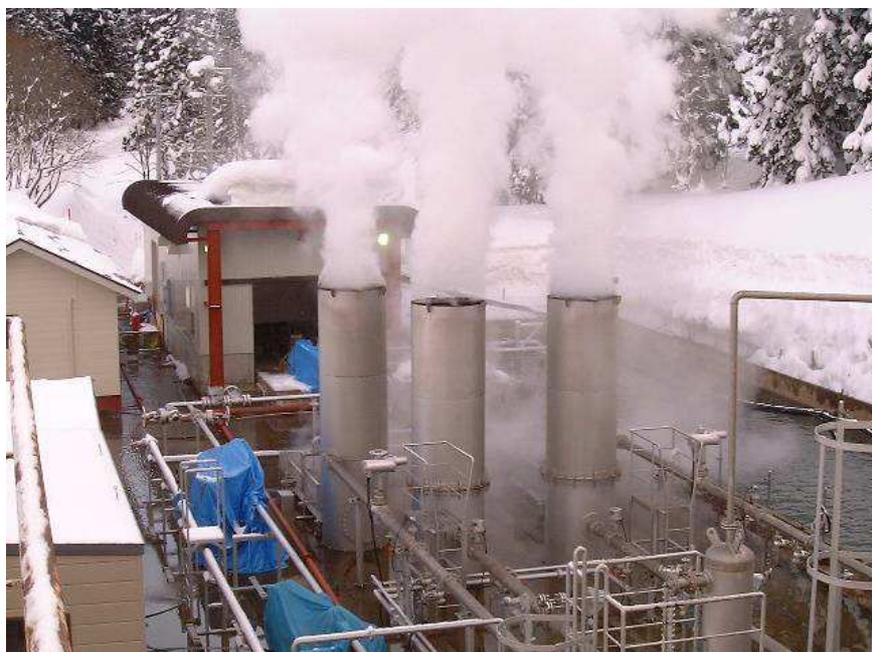
**Fig.18 肘折実験現場** 地下から回収された熱水から分離された蒸気が見られる
