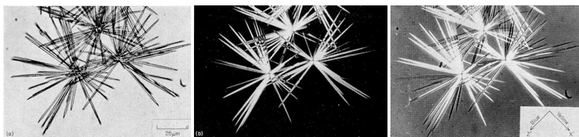
Figure 5 ポリオキシメチレン針状結晶の光学顕微鏡写真。左：通常光，中：偏光，右：偏光+クロスニコル。[5]
