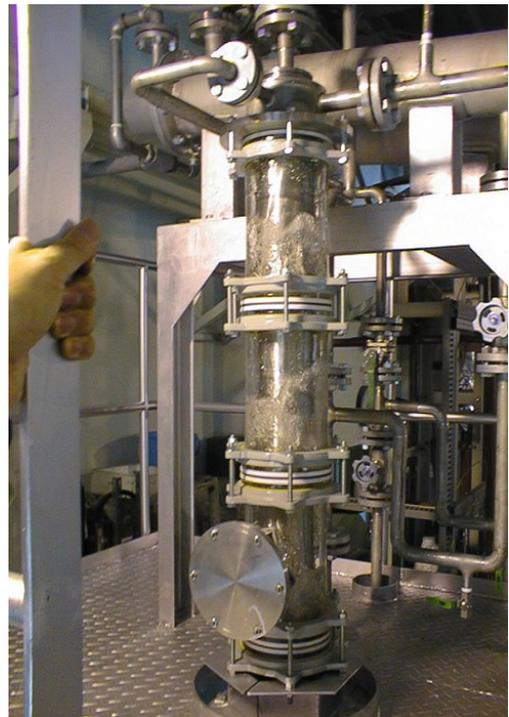
図12.同心円型HIDiCの概念図 写真7.産総研に設置された2重管型HIDiC試験装置
