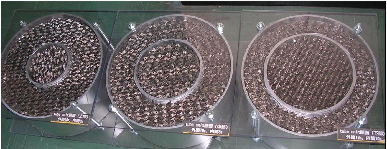
写真9 輪切りにしたHIDiC-1の内部構造 左から上部、中部、下部
