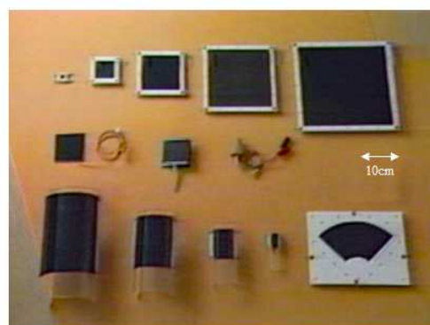
図2 各種形状&座標系の CoP 触覚センサ
