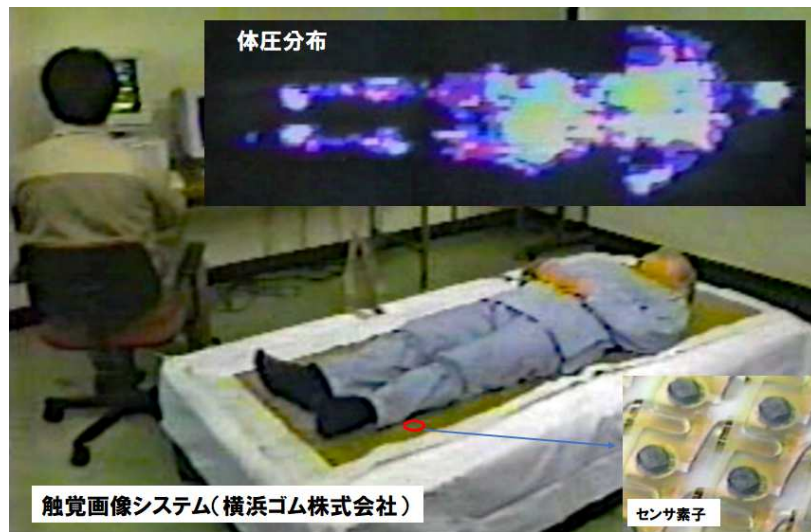
図5 横浜ゴム(株)から製品化された触覚画像システム
