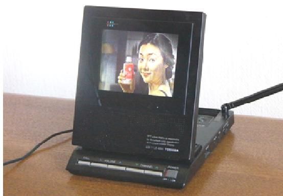
図 2 顔料分散型カラーフィルターを最初に搭載した 1988 年東芝 4 インチ液晶カラーテレビ LZ-400D (2006 年撮影市村)
