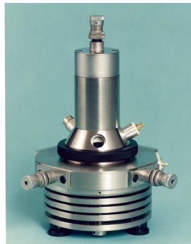
図 37 STM 方式による超粗さ測定器（小坂研 1988 年）。
