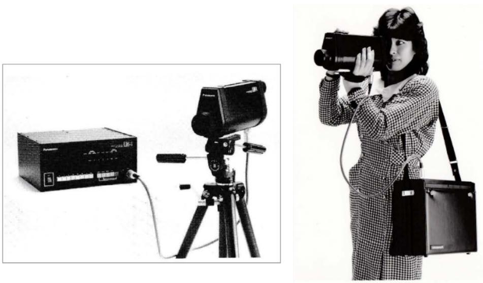
図3 薄明視ブライツメーター。左は計測部と表示部、右は持ち運びながら計測する様子。
