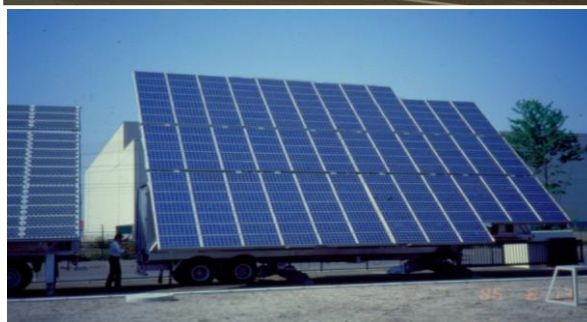
②移動式太陽電池／SPE 水電解水素・酸素供給システム (水電解システムはトレーラー内)「(株)ほくさん：1984FY 末」
