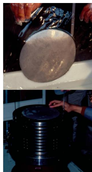
図6 接合体(Pt//Ir(Ru)[上] 電解槽の組み立て風景[下]
