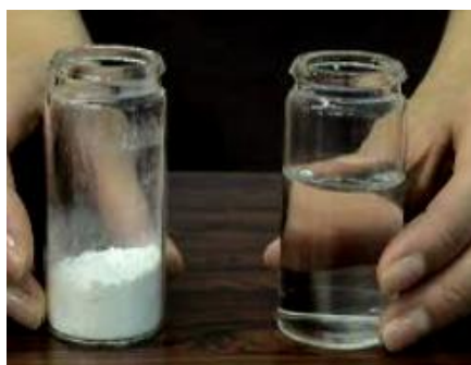
図 8．水と混合前の膨潤性 Na 雲母
