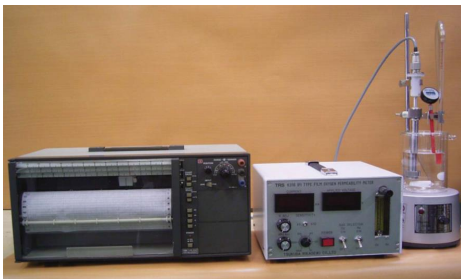
図5. 含水状態フィルム(右側の電極棒の先端)用の製科研式フィルム酸素透過率計。
