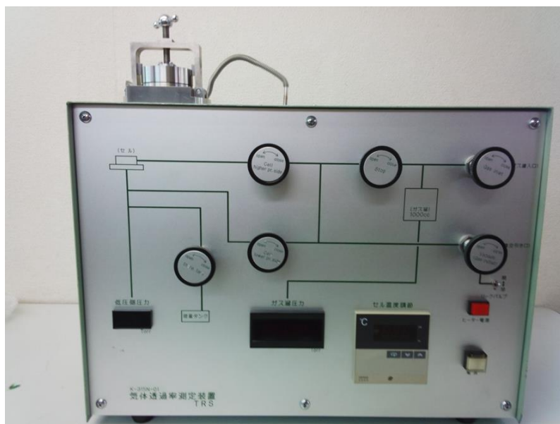
図 3. 製科研式気体透過率測定装置 (第 2 世代)
