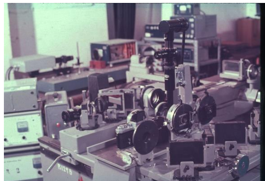
Fig.7 機械試験所に設置した画像復元装置。左図はその光学系の略図、右図は外観図
